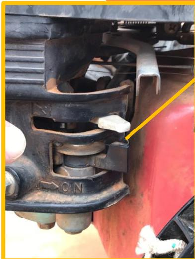
2. Benzinzufuhr (schwarz) auf "ON" und Lüftungsclappe (Weiss) nach hinten.
